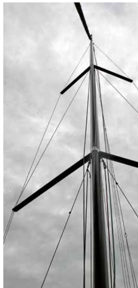
Der Mast wird über zwei gepfeilte Salingpaare mit durchlaufenden Wanten abgestagt, was nach hochwertigem Segelmaterial verlangt.
