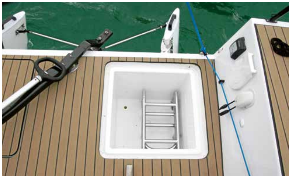
Klassische Backskisten unter den Duchten sucht man bei der N'fun 30 vergebens. Dafür sind aber die Hundekojen umso geräumiger. Zusätzlichen Stauraum, beispielsweise für Leinen und Fender, bieten die zwei „nassen“ Backskisten achtern unter dem Cockpitboden.
