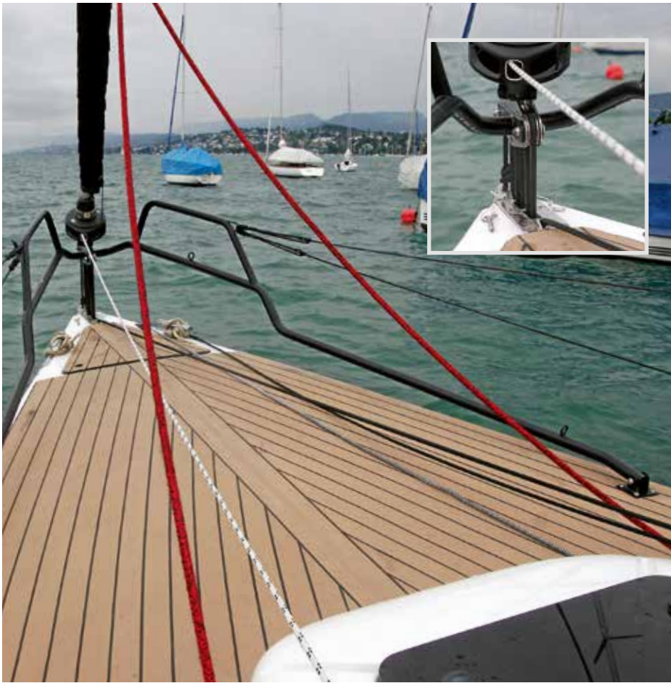
Pfiffige Lösung: Die Jüt bleibt fest montiert und fungiert gleichzeitig als Fußreling und Bugkorb. Das Jütfall ist mehrfach untersetzt. Die untere Umlenkung der Talje sitzt im Ankerkasten (kleines Bild). Bei stehendem Mast wird das Vorstag mit einem Stahlbolzen gesichert und die Talje entlastet.
