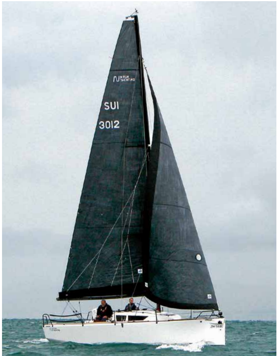
Modernes Rigg mit Squartopp-Großregel und nur wenig überlappende Fock.
