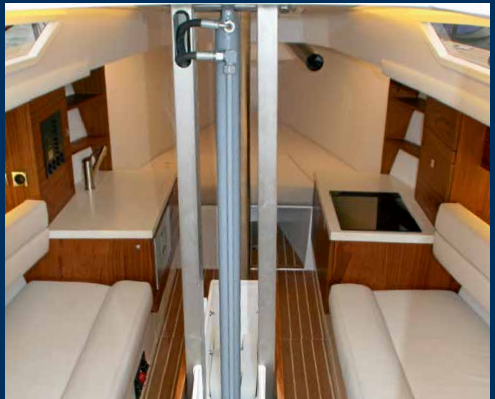
Beim ersten Blick ins Innere dominiert die Hydraulik und Mechanik des Hubkiels innerhalb des ansonsten wohnlichen Interieurs.
