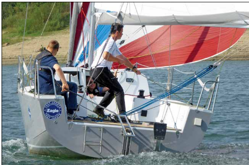
■ N Fun to jacht o oryginalnych kształtach, ma szeroką rufę z dość płaskim dnem i otwartą pawężą, łamane poszycie w tylnej części kadłuba i niemal idealnie płaski pokład. Ponadto jego kokpit ma dwa poziomy
