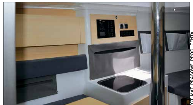
■ Mimo niewielkiej wysokości sufitu, tylko 158 cm od podłogi, można we wnętrzu tej jednostki zamontować kambuz, zlewomywak, a nawet kabinę toaletową...
