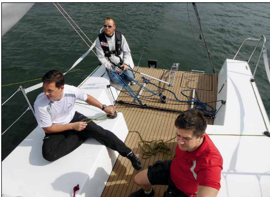
■ Dość ostre krawędzie kokpitu mogą wielu osobom nie pasować, ale pod względem funkcjonalności tę część jachtu zaprojektowano znakomicie – do wszystkich szotów, fałów i regulacji dostęp jest wręcz wzorowy
